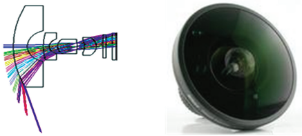
图 1 鱼镜头头结构及具体外形 Fig. 1 Fisheye lens structure and shape
